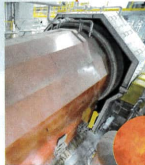
●回転ストーカ炉 回転ストーカは1時間に約1回転して、ごみを安定的に焼却します。
